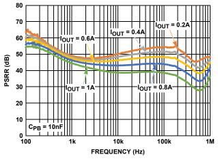
FIGURE 15. PSRR vs FREQUENCY
