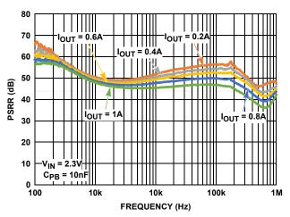
FIGURE 16. PSRR vs FREQUENCY
