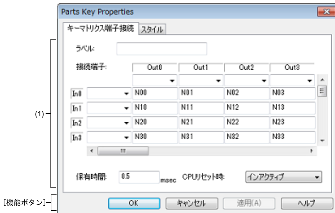
図 A.73 Parts Key Properties ダイアログ : [キーマトリクス端子接続] タブ
