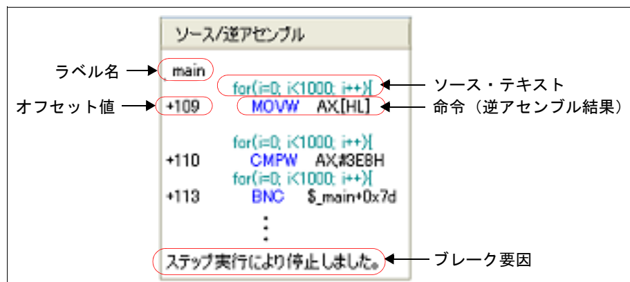
図 A.17 [ソース / 逆アセンブル] エリアの表示内容（デフォルト）
