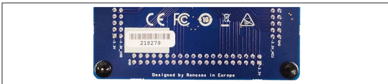
図 7 EK-RA2E1 評価ボードのシリアルナンバーの識別
