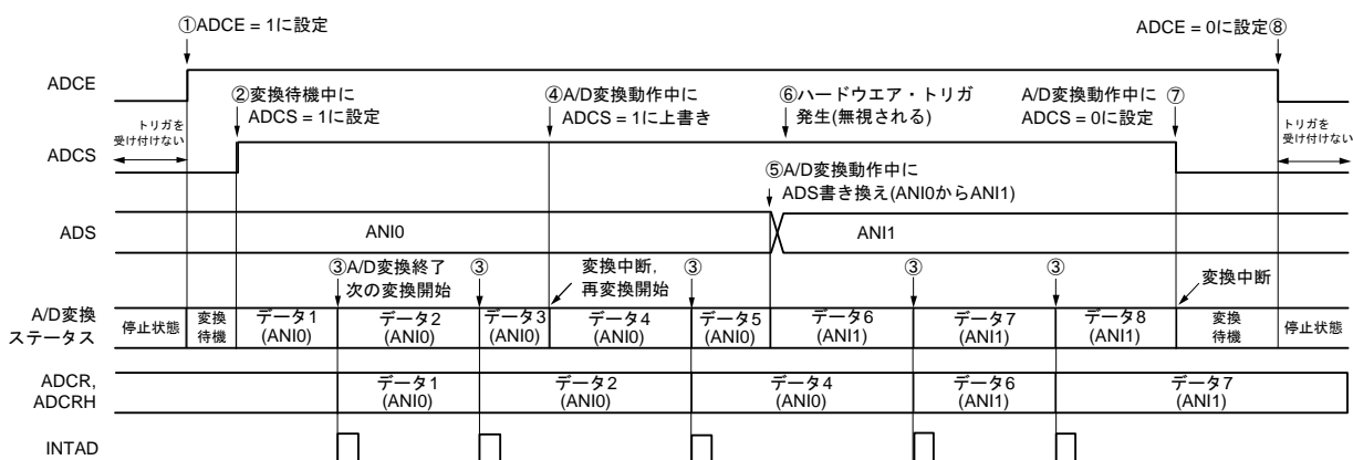
図9-17 ソフトウェア・トリガ・モード（セレクト・モード，連続変換モード）動作タイミング例
