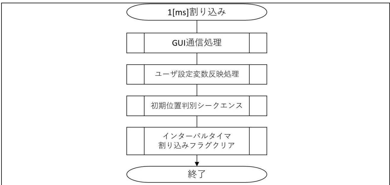
図 3-10 1 [ms]割り込み処理フローチャート
