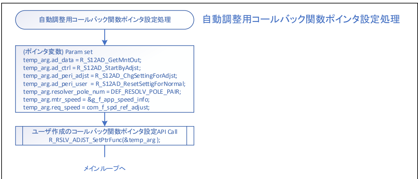
図 7.5 自動調整用初期設定（関数ポインタ設定）処理
