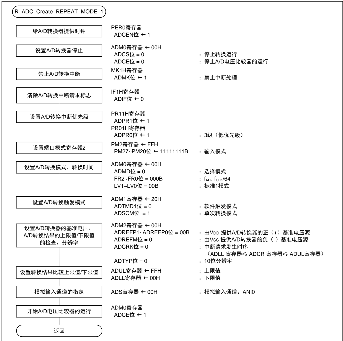
图 4.16 重复扫描模式 1 迁移时的初始化设定
