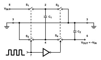
FIGURE 2. IDEALIZED NEGATIVE VOLTAGE CONVERTER
