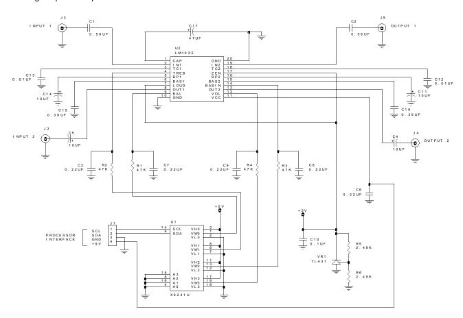
FIGURE 1. X9241 DUAL TONE/BALANCE/VOLUME CONTROLLER
