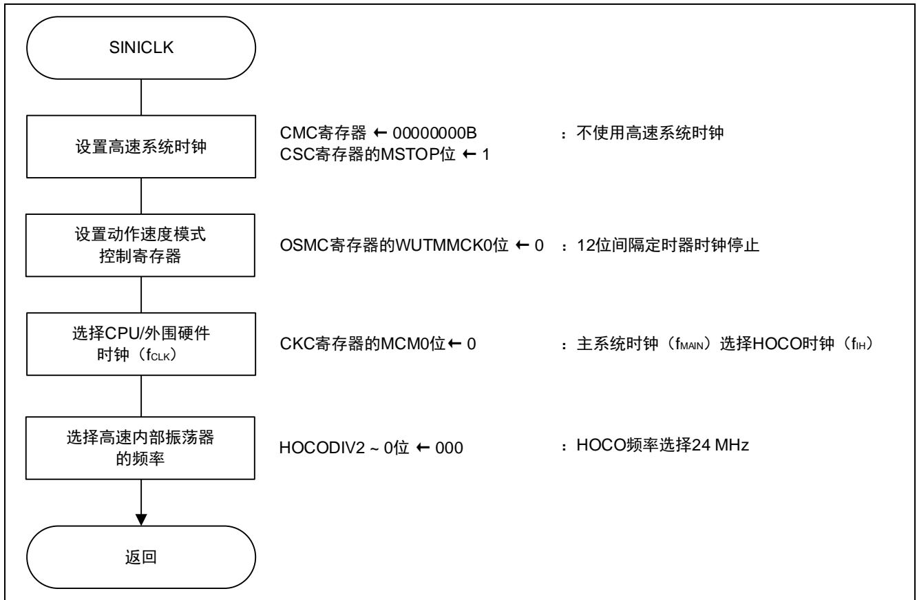
图 4.4 设置时钟发生电路
