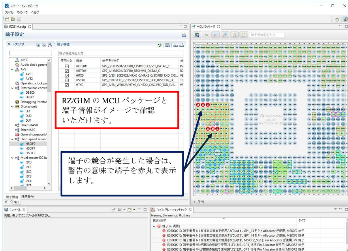
図 1 RZ スマート・コンフィグレータの GUI
