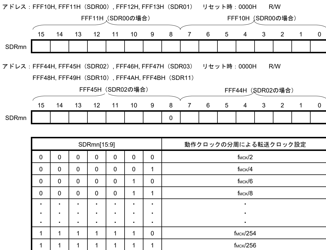
図18-9 シリアル・データ・レジスタmn (SDRmn) のフォーマット
