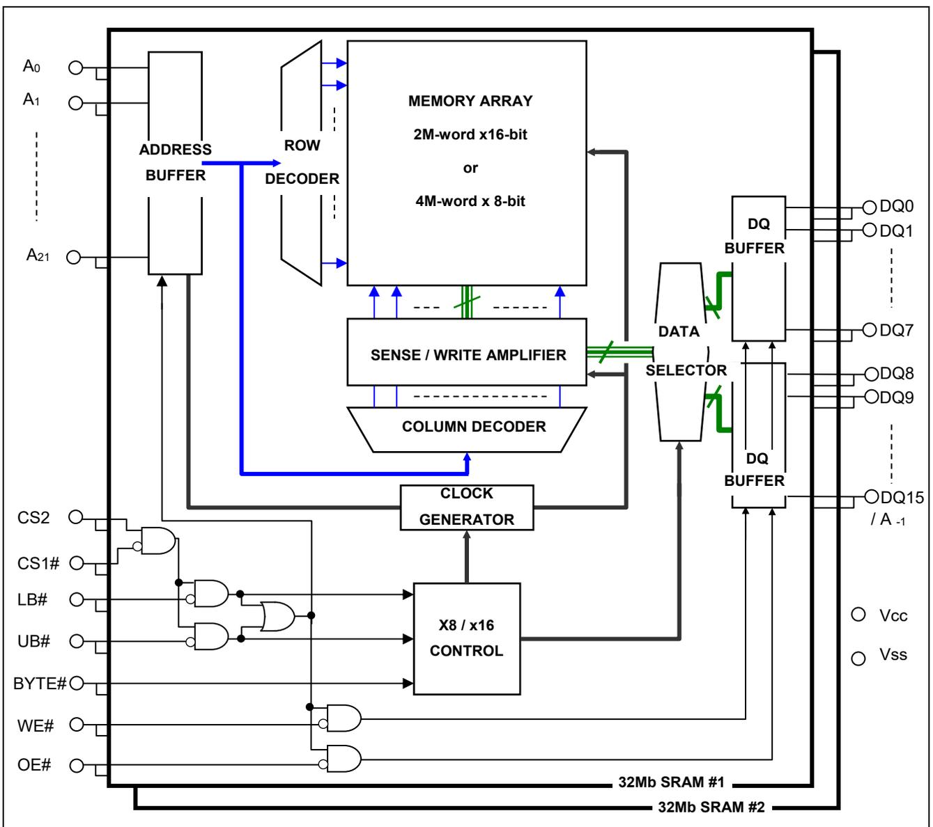
【注】 1. BYTE#ピンは 48pin TSOP (I)、52pin μTSOP (II) のみに適用。
