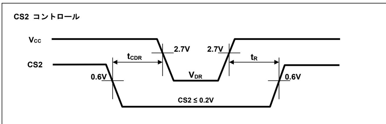
データ保持タイミング波形(3) (LB#,UB# Controlled, Word Mode 時のみ適用)<sup>\*40</sup>
