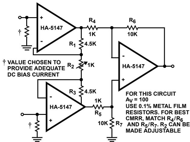
FIGURE 7. INSTRUMENTATION AMPLIFIER
