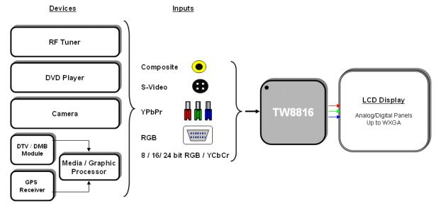
FIGURE 1. TYPICAL DIAGRAM
