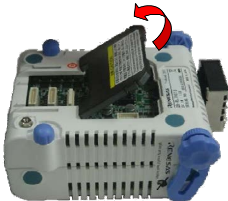
図2-1 亚克力板の取り外し方法
