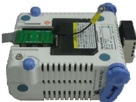
図2-5 エミュレーション・プローブの接続方法
