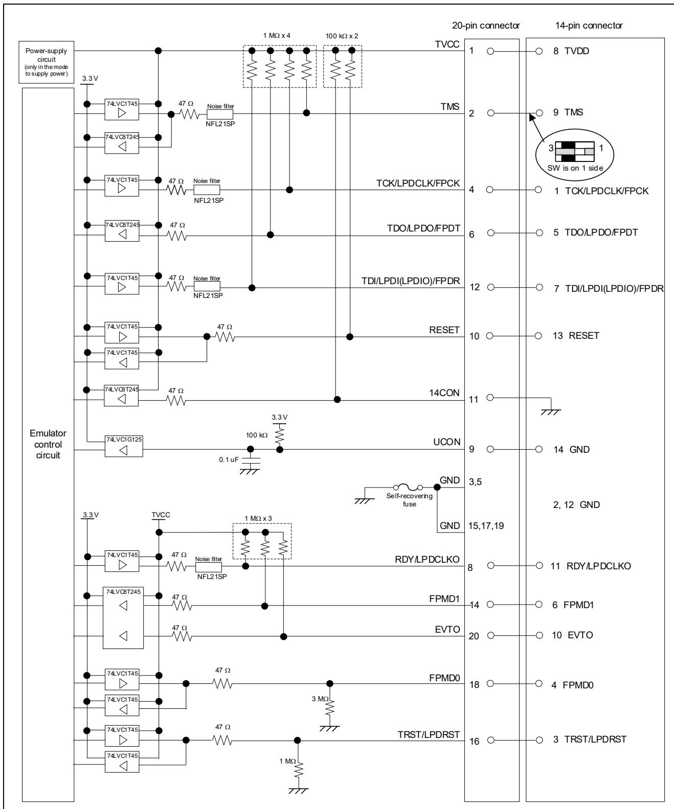
図 5-4 E2 エミュレータ(Rev.D)内インタフェース回路
