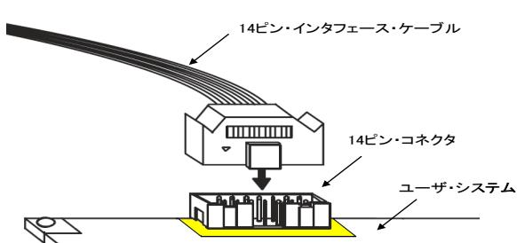
図 2-2 E1 エミュレータでの 14 ピンコネクタへのユーザインタフェースケーブル接続
