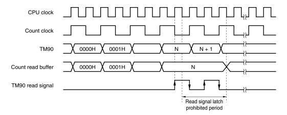
Figure 6-11. 16-Bit Timer Counter 90 Readout Timing
