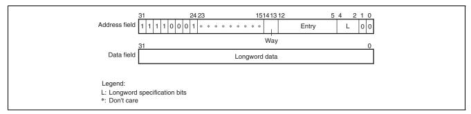
Figure 8.6 Memory-Mapped IC Data Array (Cache size = 32 Kbytes)
