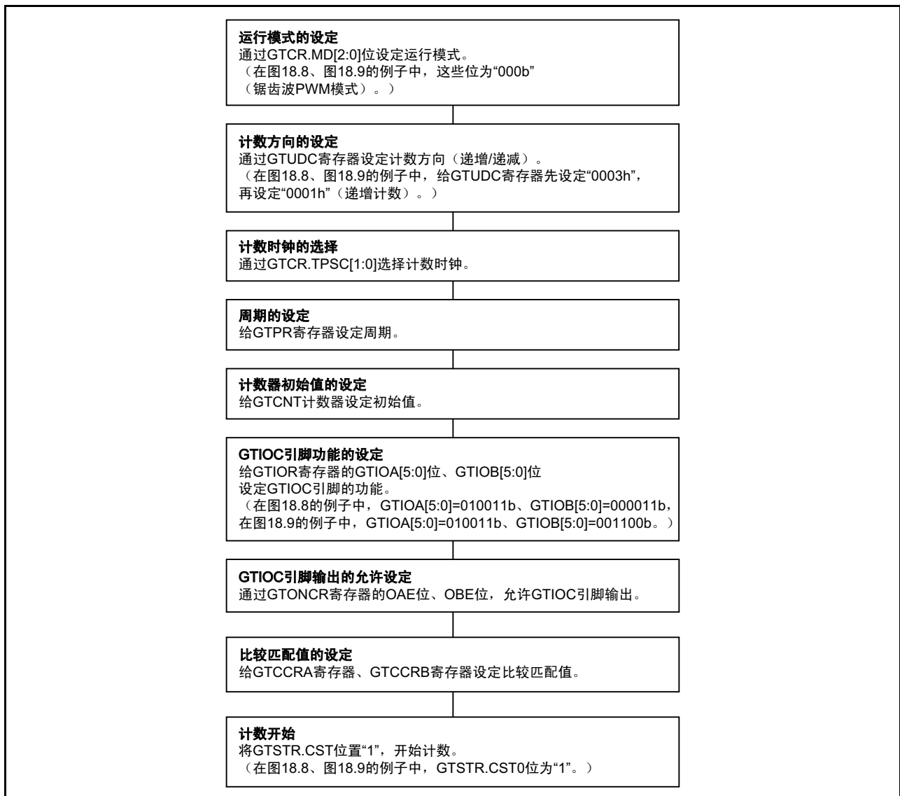
图 18.10 交替输出运行的设定例子
