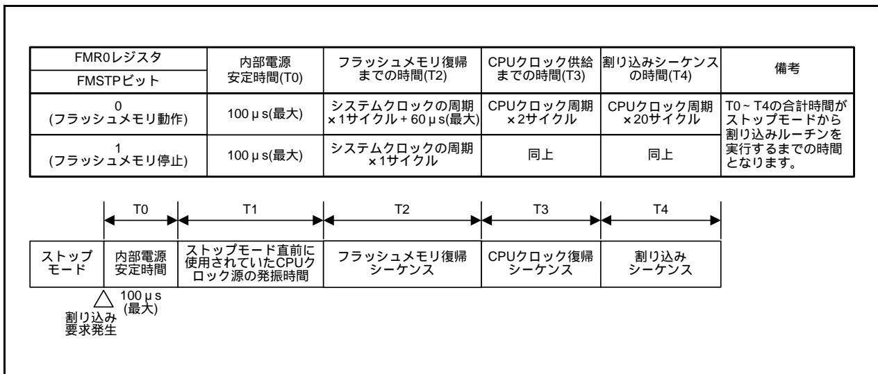
図9.8 ストップモードから割り込みルーチンを実行するまでの時間
