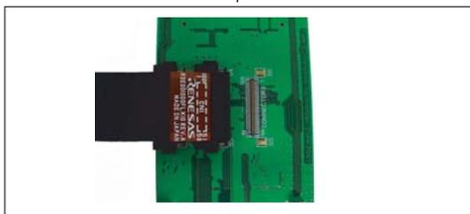
続いて「CONNECTOR2」にユーザシステムインタフェース共通ケーブル(ケーブル部)を接続します。
