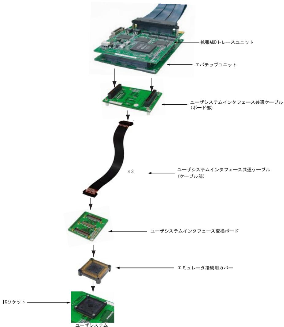
図1 ユーザシステムインタフェース変換ボード外観イメージ
