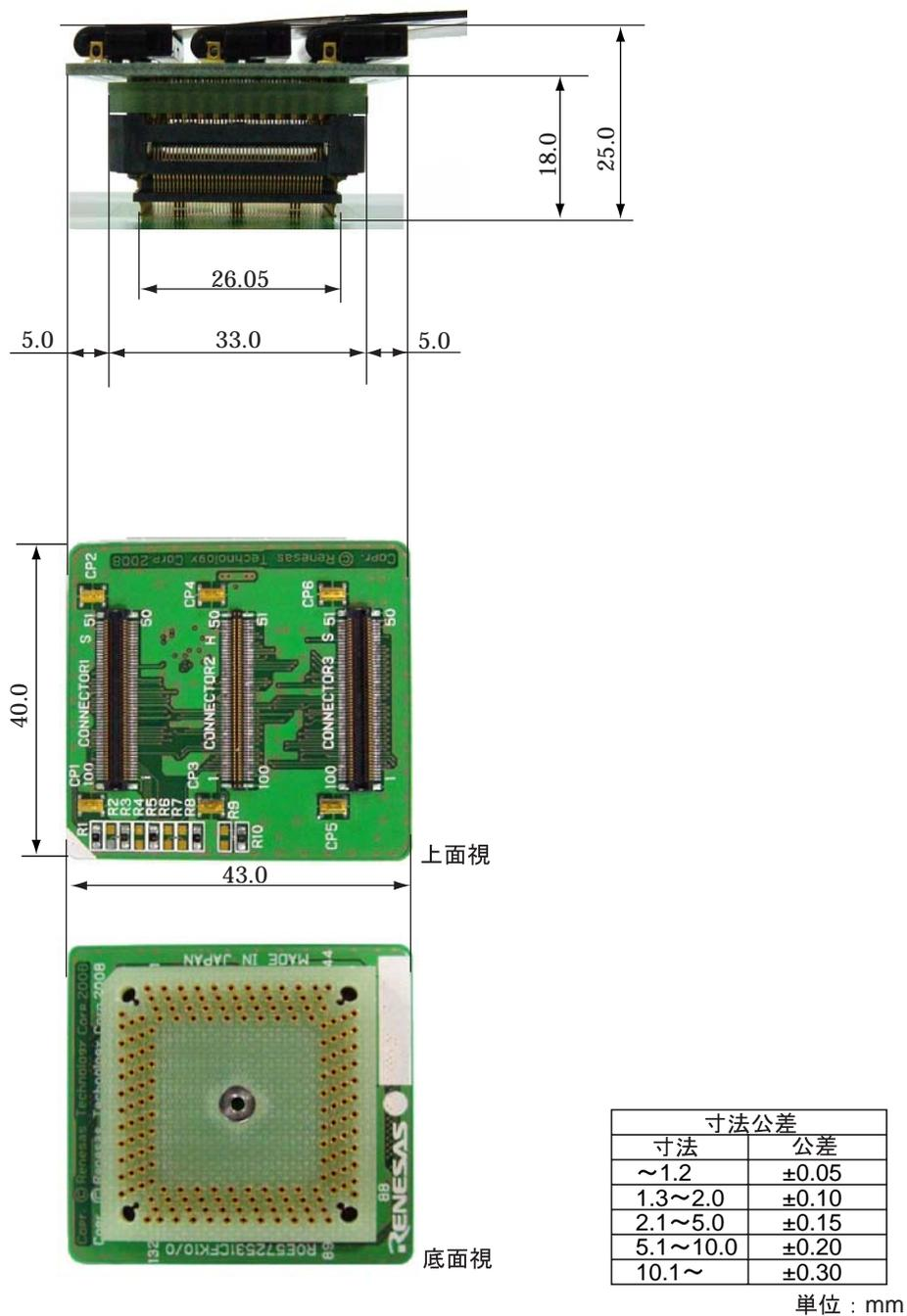
図9 ユーザシステムインタフェース変換ボード接続時のユーザシステムとの寸法
