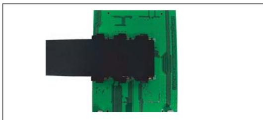
「CONNECTOR3」にユーザシステムインタフェース共通ケーブル(ケーブル部)を接続します。
