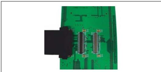
ユーザシステムインタフェース共通ケーブル(ボード部)の「CONNECTOR1」にユーザシステムインタフェース共通ケーブル(ケーブル部)を図のように接続します。
