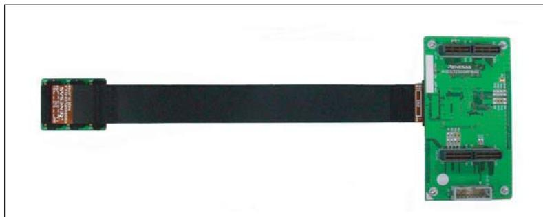
ユーザシステムインタフェース共通ケーブル(ボード部)のコネクタ番号と一致するよう、3本のユーザシステムインタフェース共通ケーブル(ケーブル部)をユーザシステムインタフェース変換ボードのコネクタに接続します。
