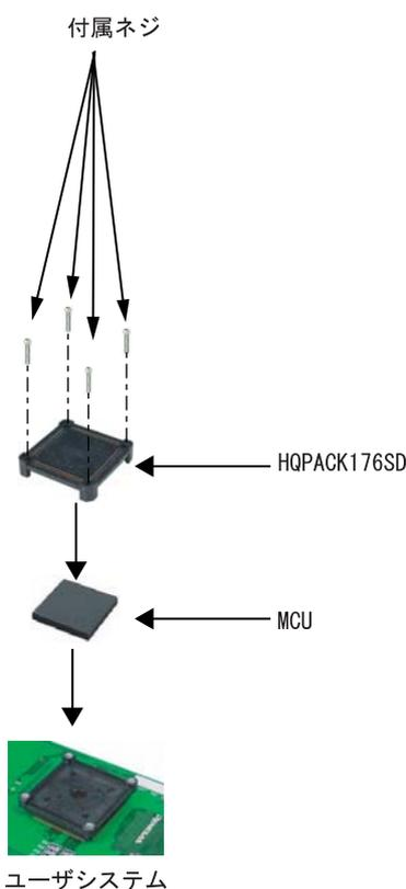
図6 MCU を IC ソケットに実装する場合
