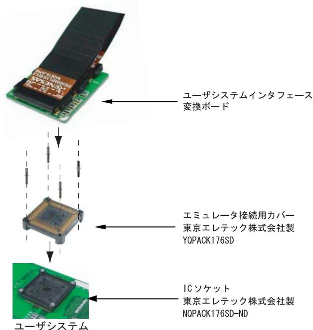
図5 ユーザシステムへの接続
