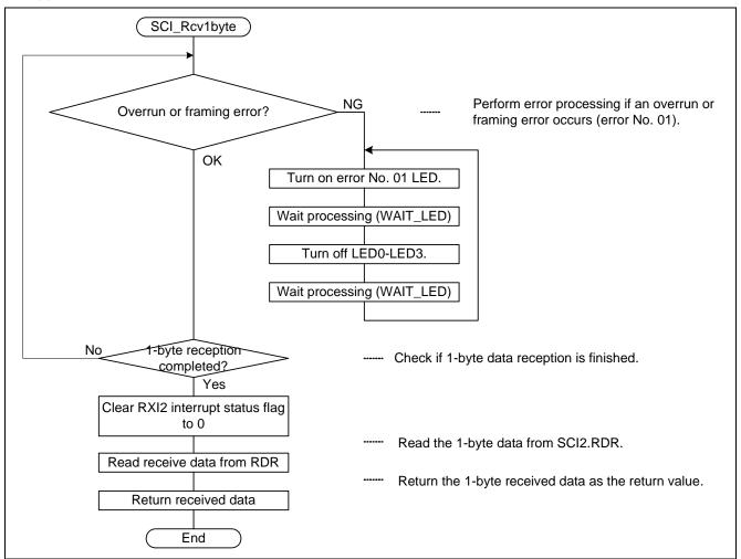
Figure 19 Flowchart (SCI\_Rcv1byte) (Master)
