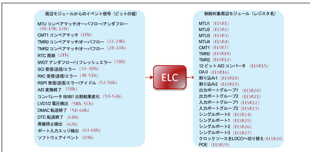
図2 イベント信号ビットの値と対象となる周辺モジュールレジスタ
