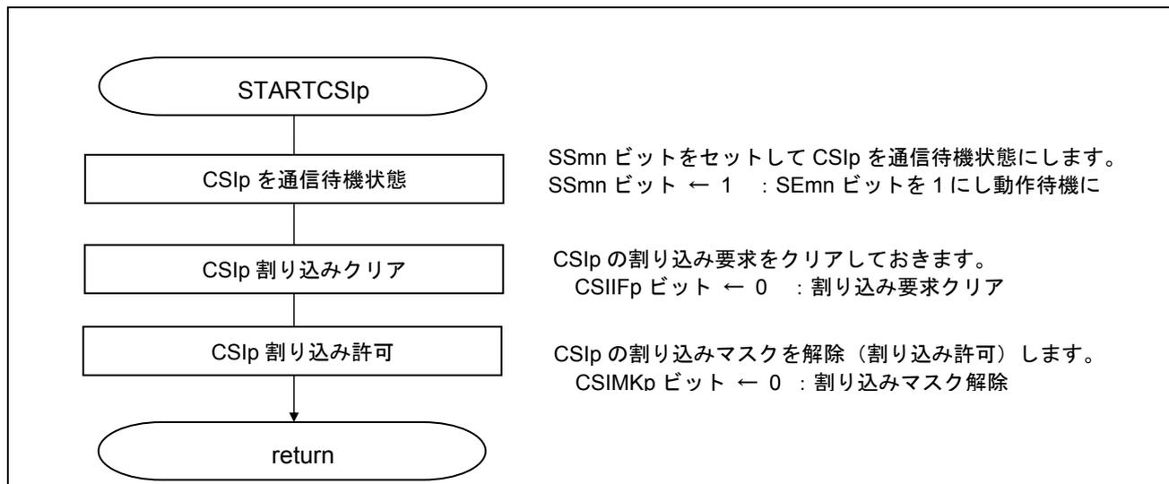
図 5.41 CSIp 通信動作許可処理
