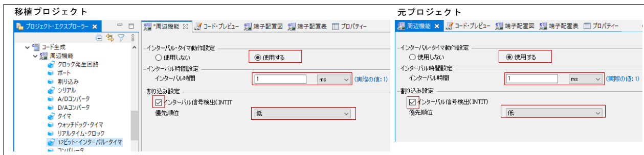
● 図 3-29 12ビット・インターバル・タイマ（移植例 2）
