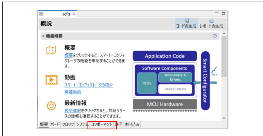
図 5-2 スマート・コンフィグレータ 「コンポーネント」タブの選択
