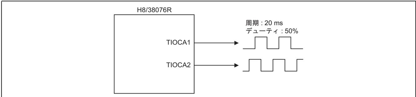
図 1 TPU 同期動作機能による PWM 出力例
