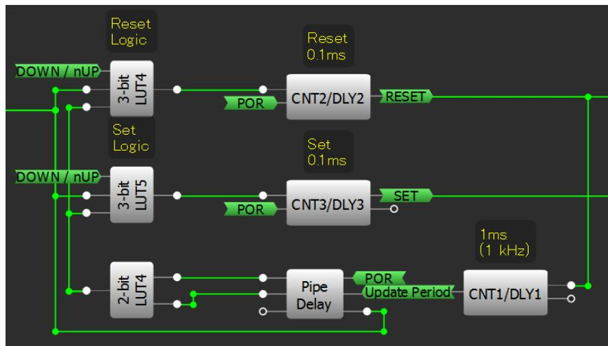
**Figure 3. PWM Circuit**
