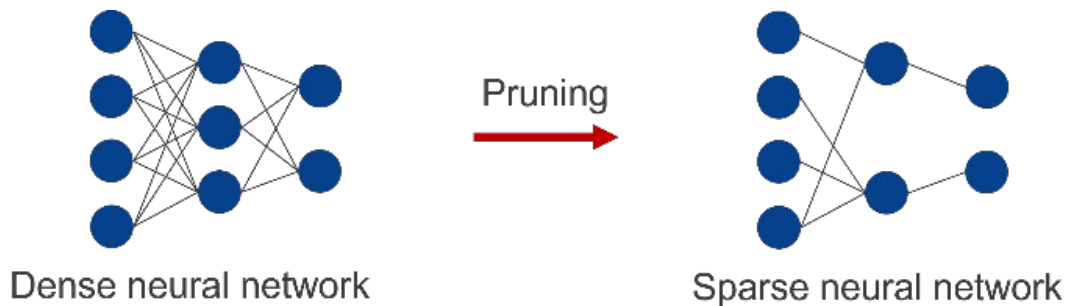
図 7: 枝刈りによるモデルの軽量化
