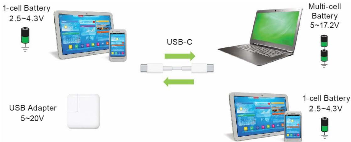
**Bild 2: Neue Stromversorgungsarchitektur auf Basis des USB-Typ-C-Steckers**
