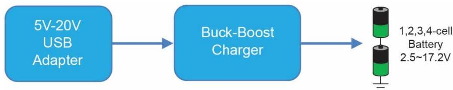
**Bild 5: Buck-Boost-Ansatz für das Laden von Akkus**
