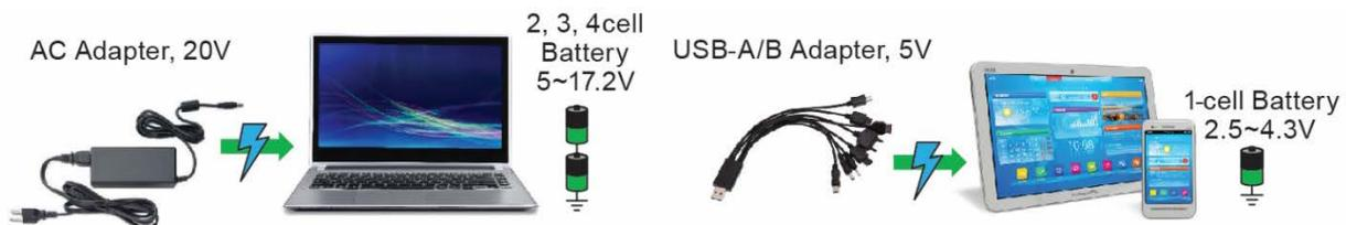
**Bild 1: Derzeitige Stromversorgungsarchitektur**
