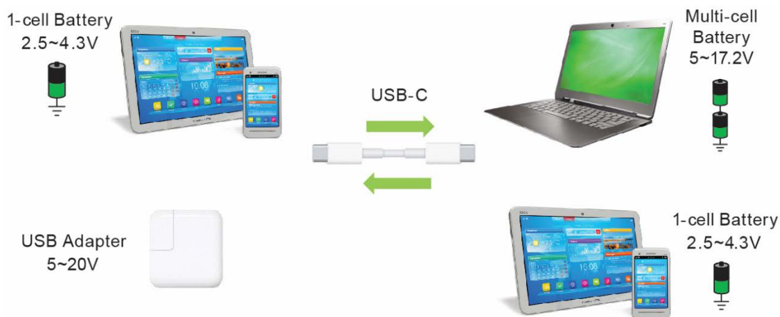
Bild 2: Neue Stromversorgungsarchitektur auf Basis des USB-Typ-C-Steckers
