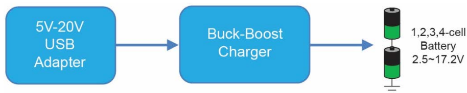
Bild 5: Buck-Boost-Ansatz für das Laden von Akkus
