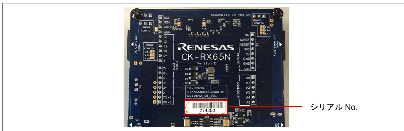
図 3 シリアル No.の表示位置（CK-RX65N v2 ボード 裏面）
