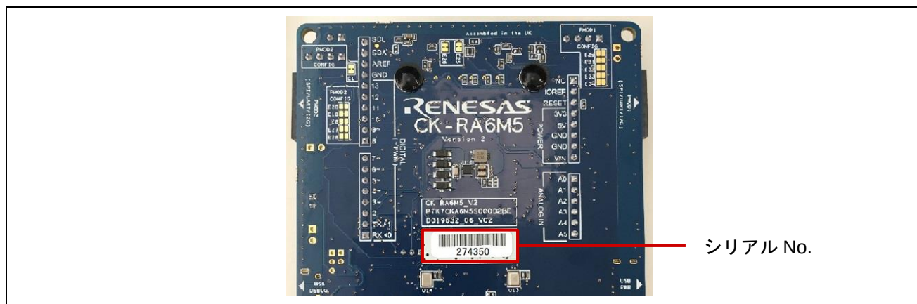
図 3 シリアル No.の表示位置（CK-RA6M5 v2 ボード 裏面）
