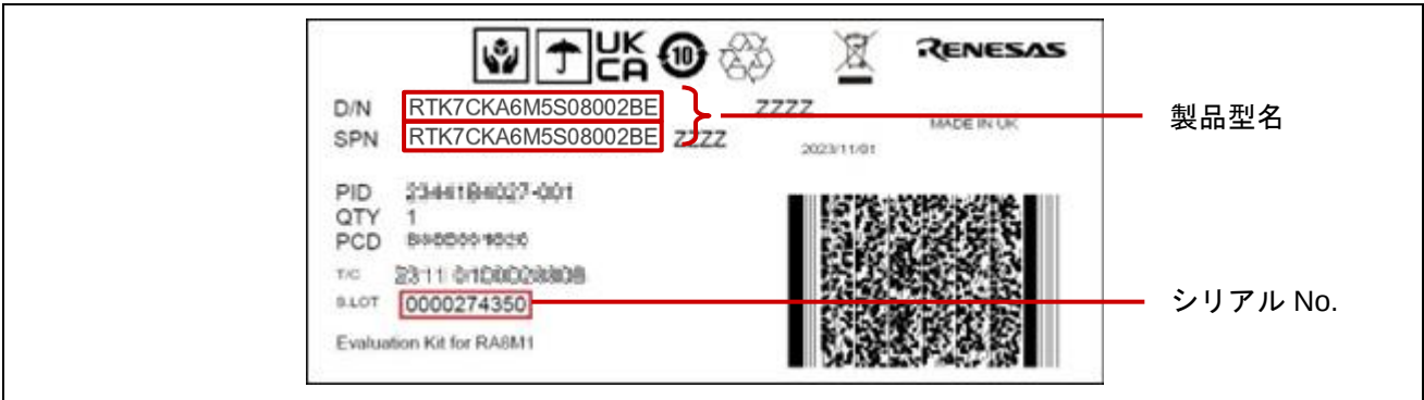
図 2 製品型名とシリアル No.の表示位置（製品個装箱 側面）
