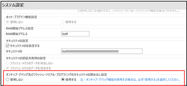
図 3-2 「オンチップ・デバッグ及びフラッシュ・シリアル・プログラミングのセキュリティ ID 読み出し設定」の設定
