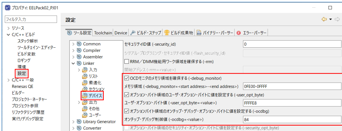
図 8-2 e 2 studio 使用時のオプション・バイトの設定(CC-RL コンパイラ)
