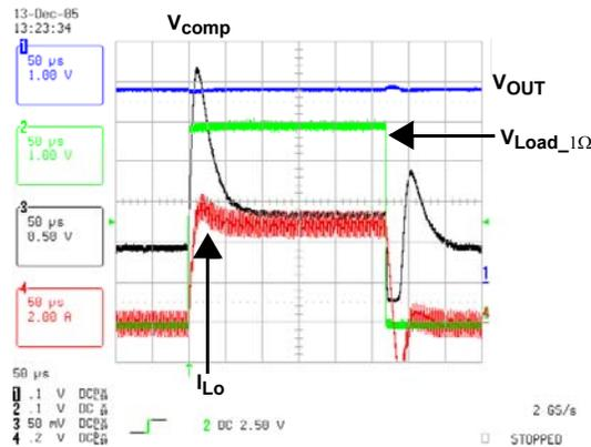
FIGURE 3. TRANSIENT RESPONSE AT 15V V<sub>IN</sub>
