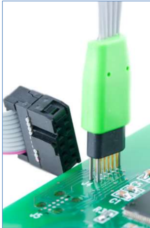
Figure 6: The actual TAG-Connect cable (10 pins)
