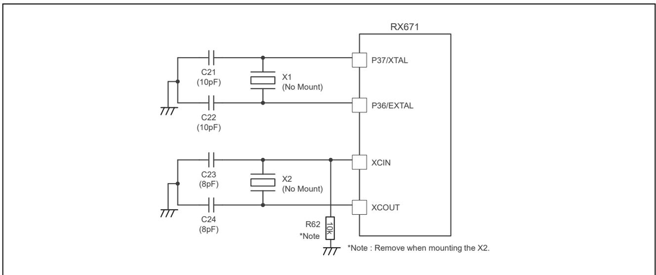
**Figure 2-8. Clock Circuit**
