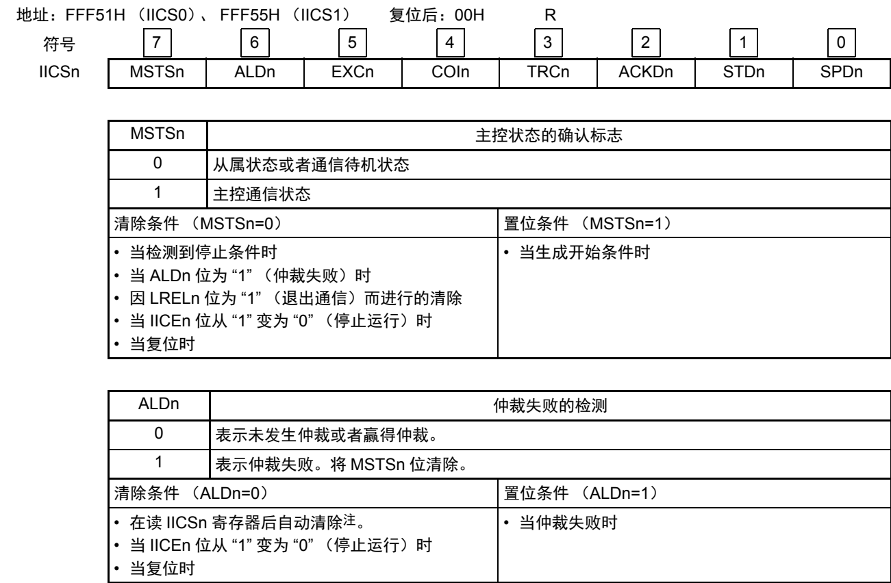
图 13-7 IICA 状态寄存器 n (IICSn) 的格式 (1/3)
