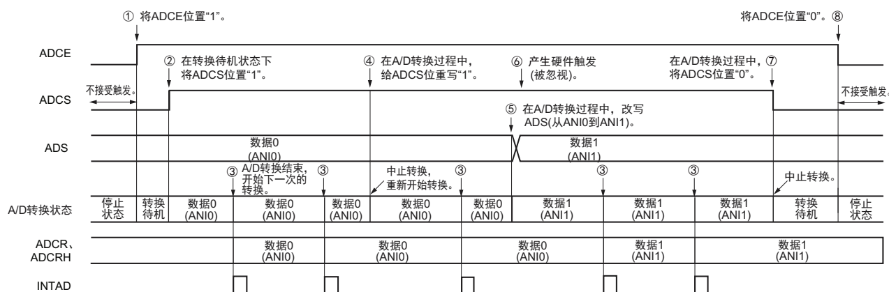
图 11-17 软件触发模式（选择模式和连续转换模式）的运行时序例子
