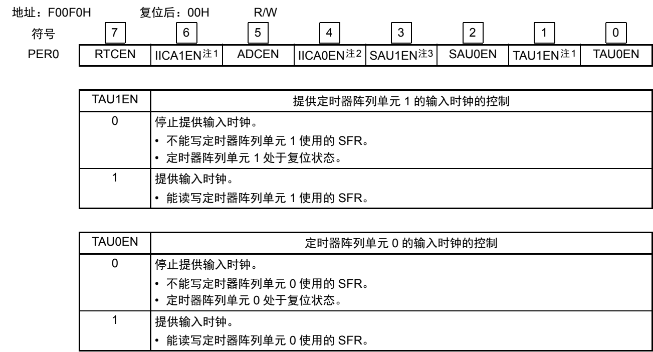
图 6-9 外围允许寄存器 0（PER0）的格式
