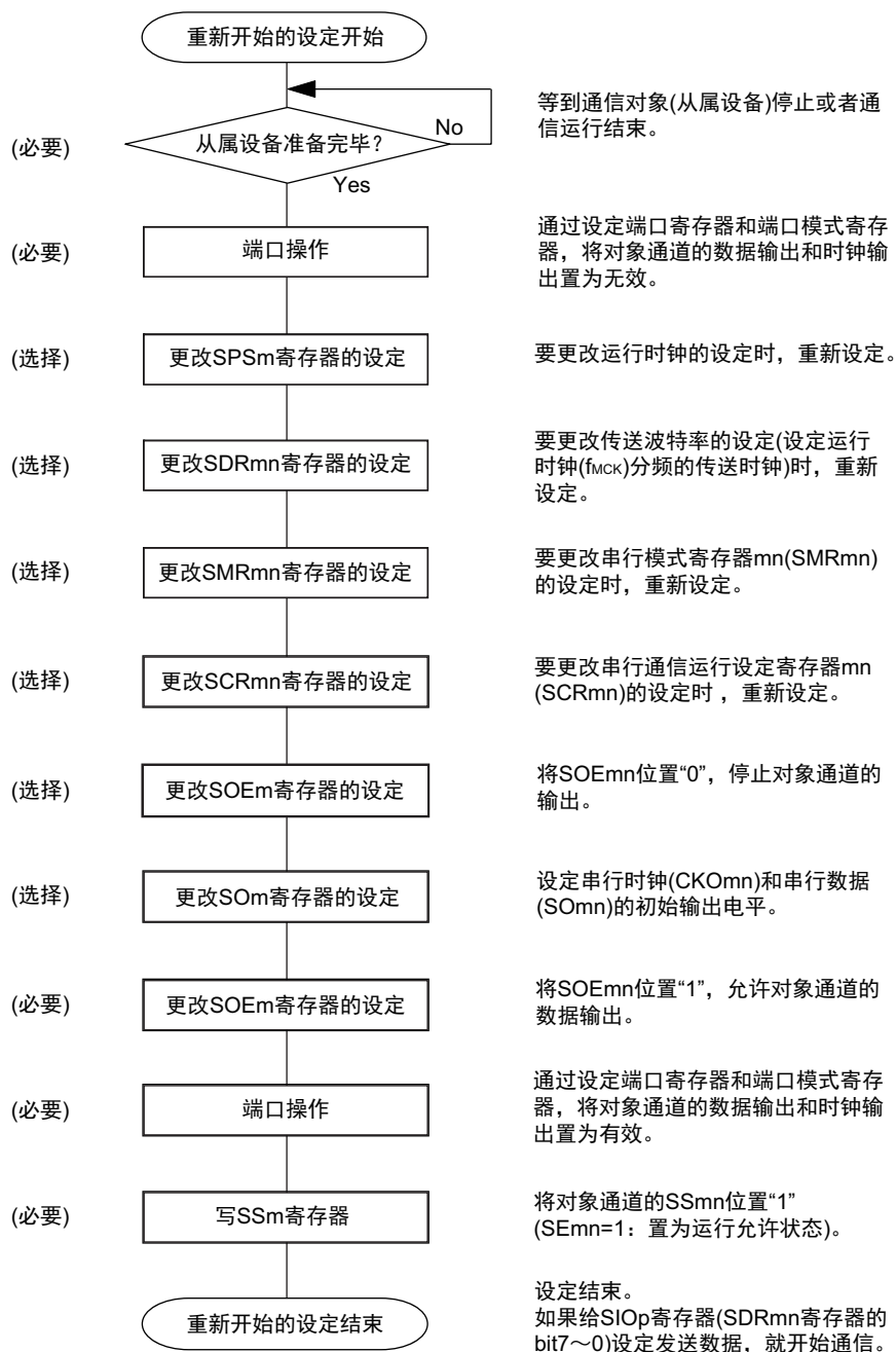
图 12-28 重新开始主控发送的设定步骤
