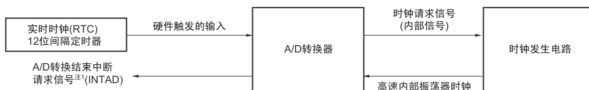
图 11-34 使用 SNOOZE 模式功能时的框图
