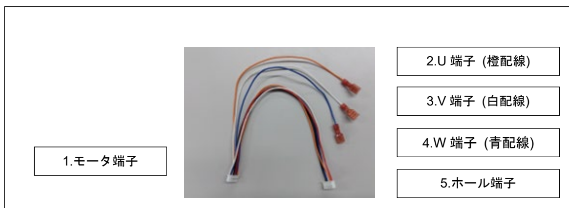
Figure 2-5 モータ接続ケーブル接続先
