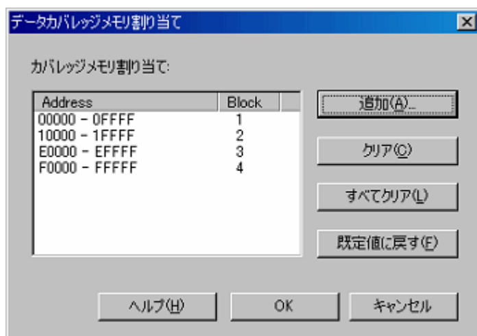
図 5.89 [データカバレッジメモリ割り当て] ダイアログボックス
