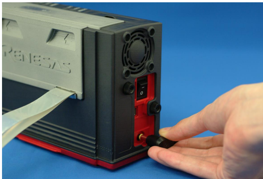
図2.5 エミュレータ用電源の接続
