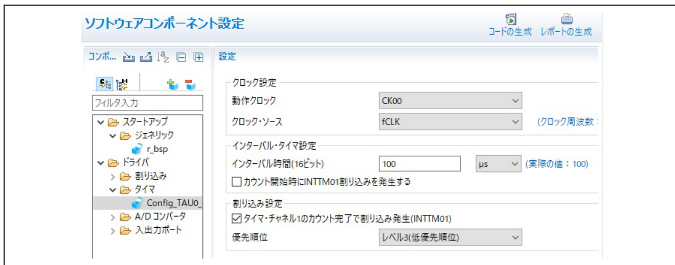
図 2.16 スマート・コンフィグレータのインターバル・タイマ (TAU0_1) の設定画面
