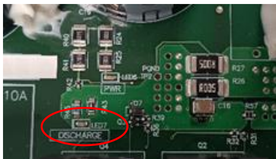
図 4-2 放電制御 LED
