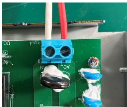
図 3-9 AC 電源コネクタ
