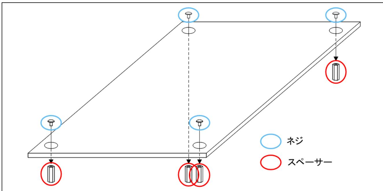
図 4-3 スペーサおよびネジの取り付け
