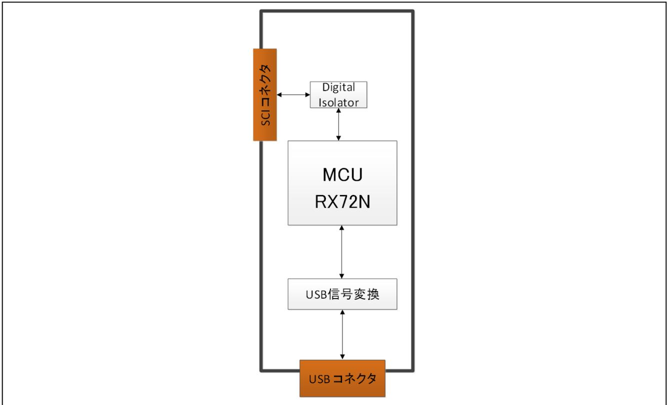
図 4-1 通信ボードのブロック図
