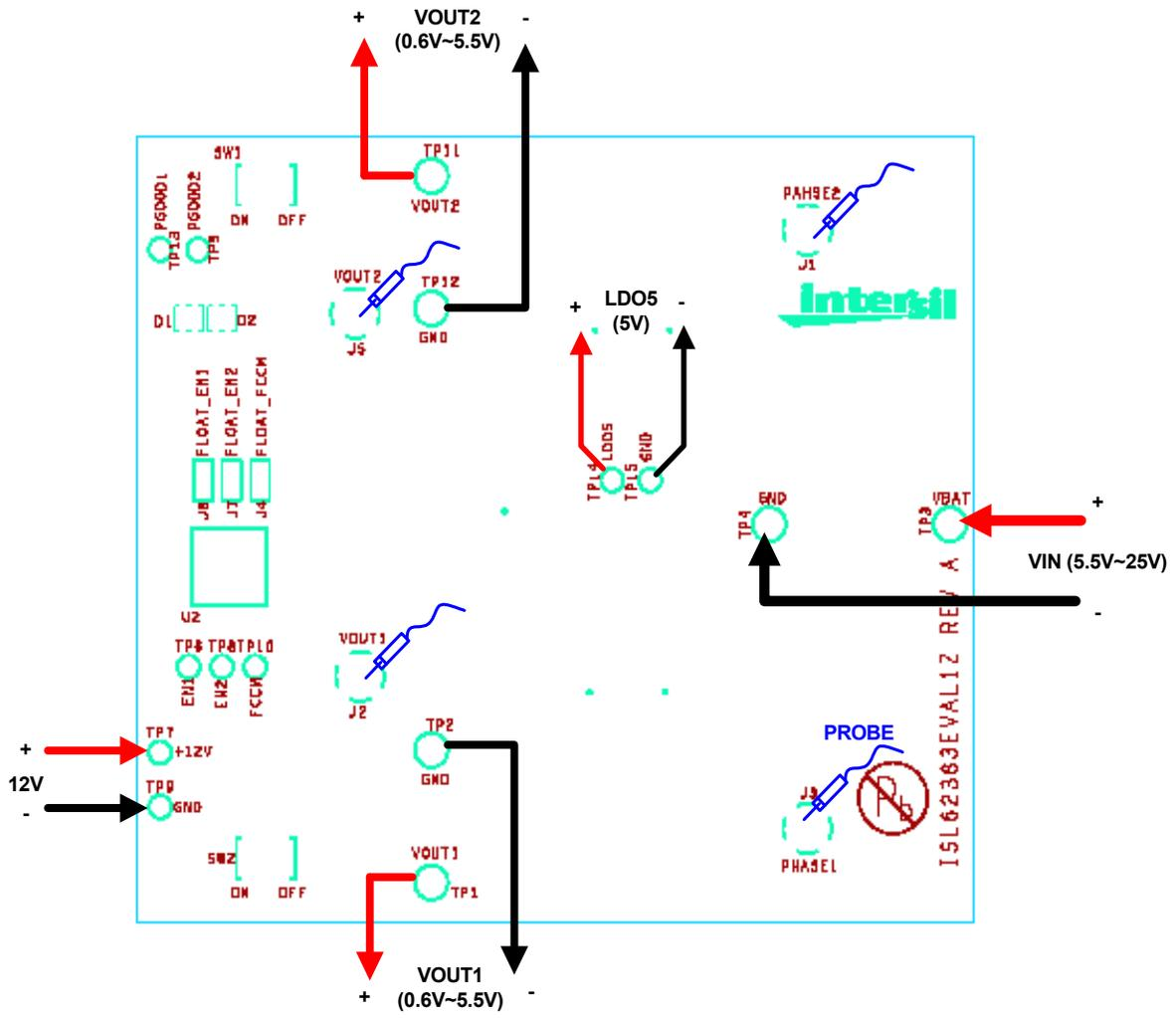
FIGURE 2. TYPICAL TEST CONFIGURATION
