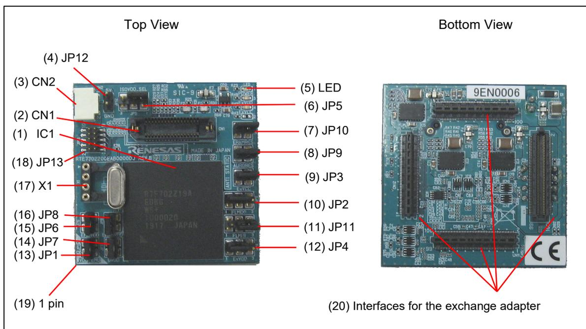
図 2-1 エミュレーションアダプタ (RTE7702200EAB00000J) 各部の名称
