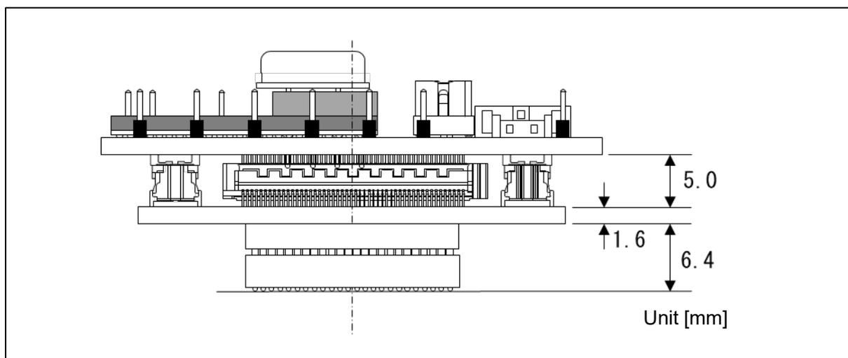
図 A-6 RTE7702300CBG373T000J 組立図 (373pin)
