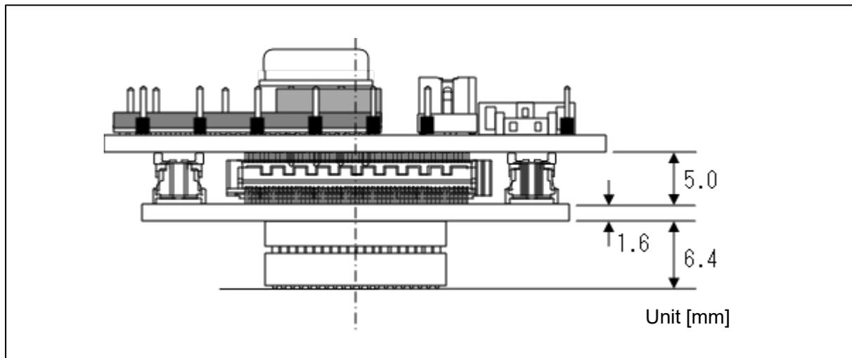
図 A-7 RTE7702300CBG292T000J 組立図 (292pin)
