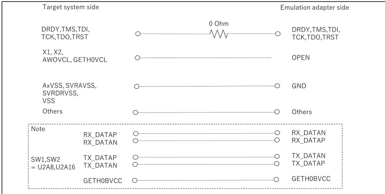
Note :エミュレーションアダプタ（デバッグチップ）として、Ethernet AVB(SGMII)のエミュレーションはできません。エクスチェンジアダプタ上では DATAP と DATAN を接続していますが、デバイスが破壊されることはありません。
