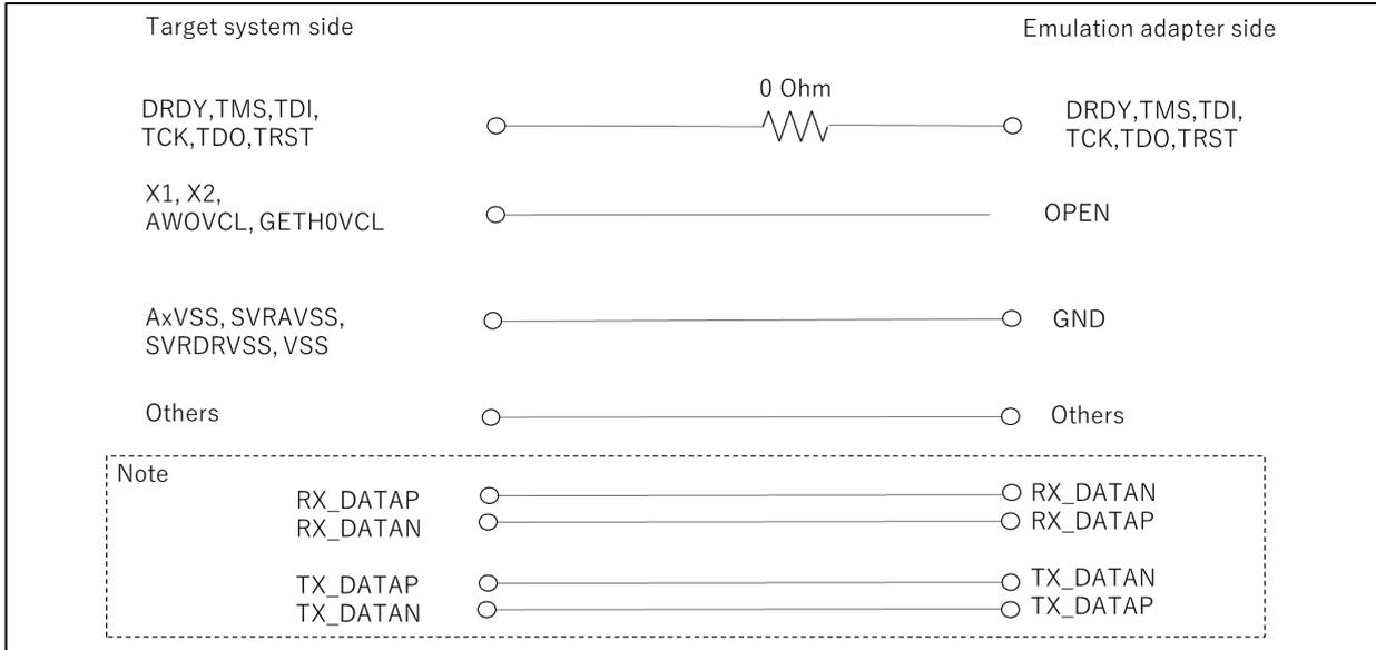
Note :エミュレーションアダプタ（デバッグチップ）として、Ethernet AVB(SGMII)のエミュレーションはできません。エクスチェンジアダプタ上では DATAP と DATAN を接続していますが、デバイスが破壊されることはありません。
