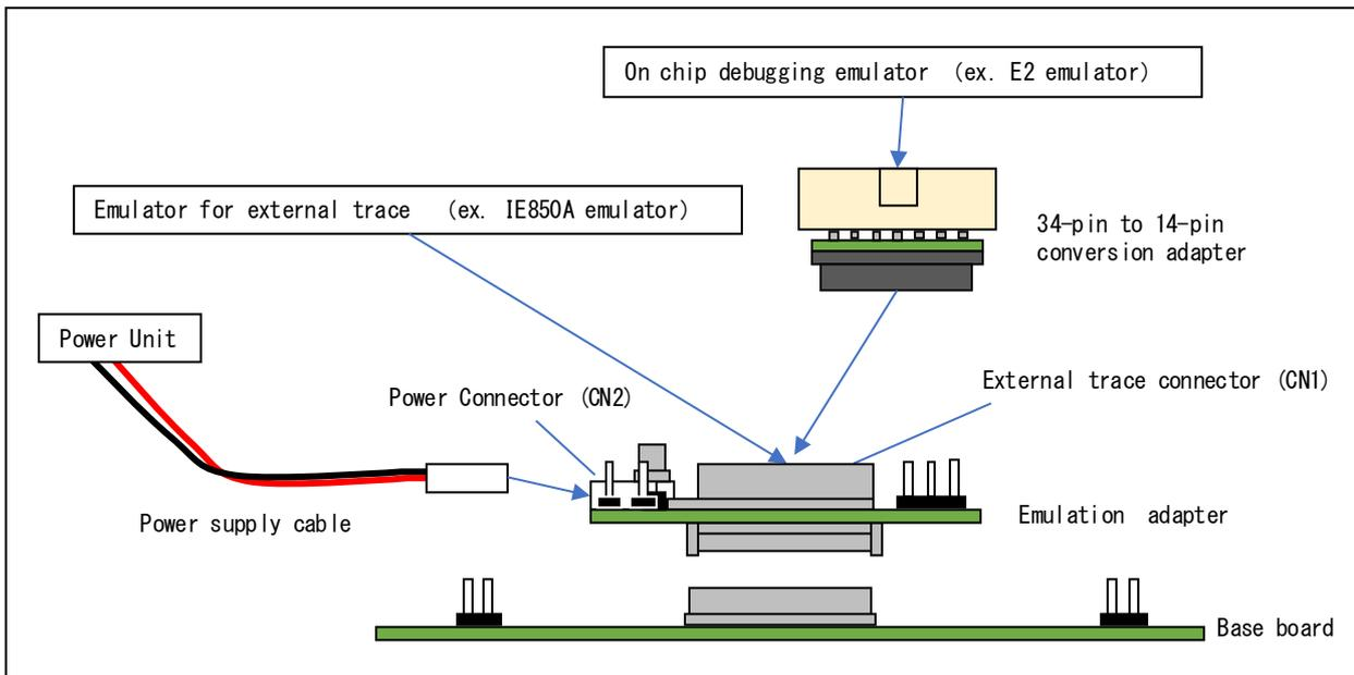
図 3-1 システム構成（簡易評価ボード）
