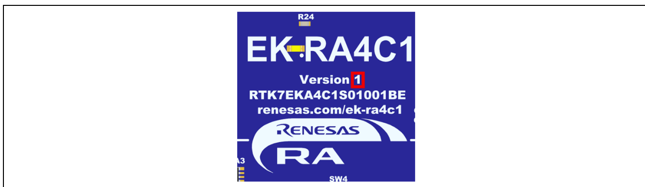
図 4 EK-RA4C1 評価ボード本体のキットバージョンの識別
