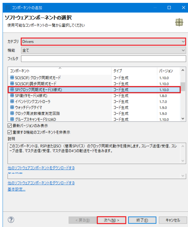
図 4-36: SPI クロック同期式モード選択
